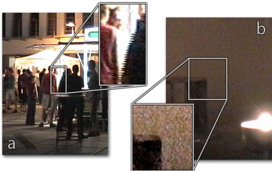
Abbildung 2: Probleme in Videobildern: a) Interlacing (vergrößert), b) Dunkelstrom-Rauschen (verstärkt)
